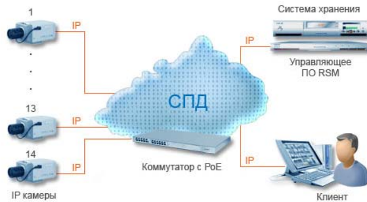
Рисунок. Обобщенная схема системы видеонаблюдения, построенной на базе компьютерных сетей с протоколом TCP/IP
